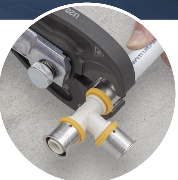
**06** Odklepanje in odstranitev čeljusti z nastavka. Priključek je pripravljen za preskus tesnosti.
