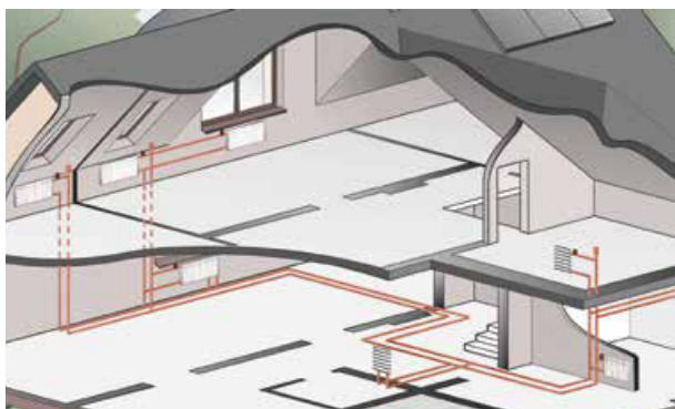
„Vertikalni“ sistem v ogrevalni napeljavi
